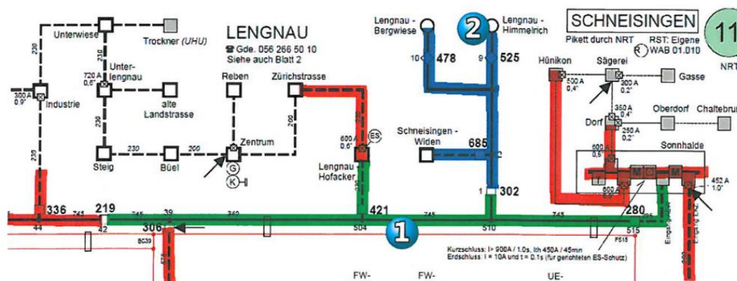
Bild 2: Ausschnitt 16-kV-Versorgungsnetz AEW
